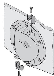
Montar el conducto en la brida con los tornillos y arandelas planas suministrados.
