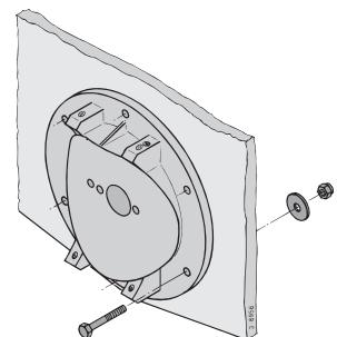
Bringen Sie die beiden zum Lieferumfang gehörenden Zinkanoden an.
