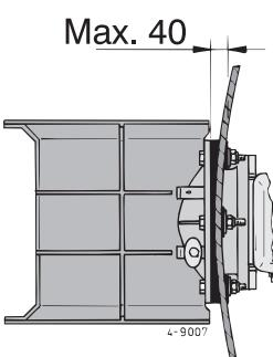
Bietet der Spiegel für den Einbau der Heckschraube nicht die ausreichende Höhe, kann zur Montage der Schraube gegebenenfalls eine Schräge geschaffen werden. Bedenken Sie, daß das Tunnelrohr dann jedoch gegen die während der normalen Fahrt einwirkende Kraft des Wassers geschützt werden muß. Das Tunnelrohr sollte nach Möglichkeit nicht über die Fläche hinausragen.
