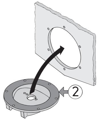
Der Flansch wird mittels der zum Lieferumfang gehörenden Schrauben, Muttern und Unterlegscheiben befestigt.
