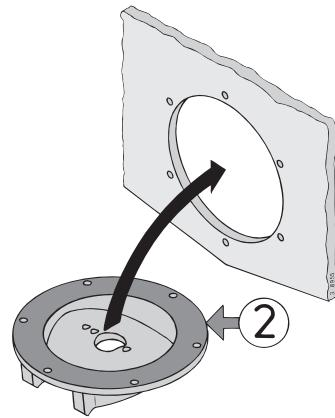
Monter la bride à l'aide des boulons, écrous et rondelles de blocage fournis.
