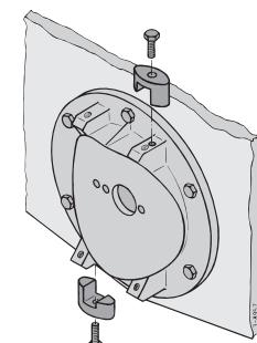
Schließen Sie mit Hilfe der zum Lieferumfang gehörenden Schrauben und Unterlegscheiben den Tunnel an den Flansch an.
