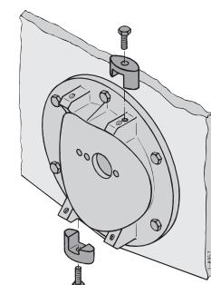
Monter le tunnel sur la bride à l'aide des boulons et rondelles de blocage fournis.
