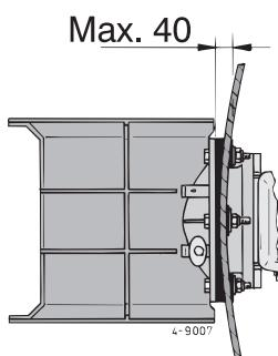
Si el espejo no ofrece la altura suficiente para el montaje de la hélice de popa, se puede elaborar eventualmente una superficie oblicua para montar la hélice de popa. Tómese en cuenta que en este caso es necesario proteger el conducto contra la fuerza producida por el agua durante una navegación normal. Es conveniente no dejar salir por debajo del plano el conducto.
