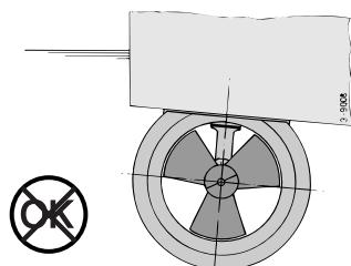
**BELANGRIJK:** De hartlijn van de boormal dient **exact** horizontaal te liggen en tenminste 185 mm onder de waterlijn.
