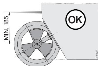
Nous ne conseillons pas de monter l'hélice dans la plan du navire. Le tunnel n'a pas été prévu pour les forces de l'eau qui sont alors générées durant la navigation normale. Le propulsion normale du bateau en serait également fortement freinée.
