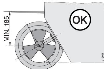
Von einer Montage am Boden des Schiffs wird abgeraten. Der Tunnel ist auf die in einem solchen Fall während der normalen Fahrt auftretenden Kräfte des Wassers nicht ausgelegt. Außerdem wird das Schiff auch in seiner normalen Fortbewegung stark gebremst.
