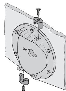
Montare il tunnel sulla flangia con i dadi e le rondelle. **Munire questi dadi, M6x20, di un dispositivo di bloccaggio.**
