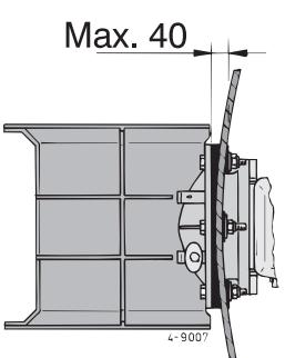
Se lo specchio di poppa non offre un'altezza sufficiente per il montaggio dell'elica, si può eventualmente applicare un piano inclinato. Ricordare, in questo caso, di proteggere il tunnel dalla forza dell'acqua durante la navigazione normale. È preferibile non lasciare che il tunnel fuoriesca al di sotto della carena.
