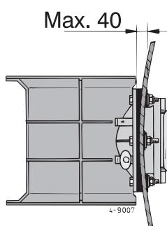
Indien de spiegel onvoldoende hoogte biedt voor de montage van de hekschroef kan eventueel een schuin vlak worden gemaakt om de hekschroef te monteren. Denk er aan dat de tunnelbuis dan wel beschermd moet worden tegen de optredende kracht van het water tijdens de normale vaart. Laat de tunnelbuis bij voorkeur niet onder het vlak uitsteken.
