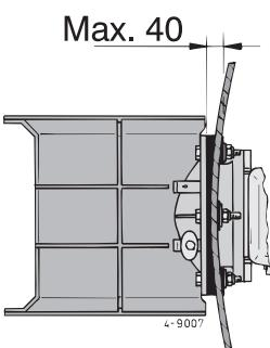
Si l'arcasse présente une hauteur insuffisante pour le montage de l'hélice de poupe, on peut éventuellement créer une surface inclinée pour monter l'hélice de poupe. Pensez que le tunnel tubulaire devra être protégé contre la force de l'eau qui est générée pendant la navigation normale. Evitez de faire dépasser le tunnel tubulaire sous la surface.
